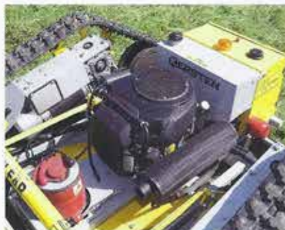
Der Motor von Honda leistet knapp 21 PS. Er treibt den Generator (rot, vorne) und über einen Riementrieb das Mähdeck an.
