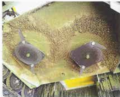
Zwei Mäheller sind serienmäßig mit je zwei frei schwingenden Klingen ausgestattet. Zwei weitere Klingen lassen sich montieren.
