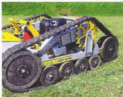
Das 150 mm breite Gummilaufband wird mit dem gelben Speichenrad angetrieben. Ein Bügel schützt vor Überschlägen.
