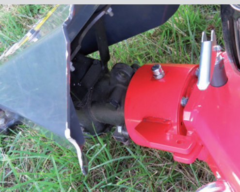
Untersetzungsgetriebe für besondere Laufruhe
