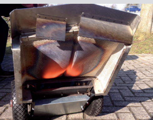
Deflektorplatte für randnahes Arbeiten durch kontrollierte Abführung der heißen Luft
