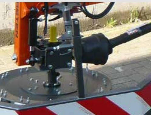
Wechselbarer Bürstenteller mit verschiedenen Werkzeugen (Austausch mit nur einer Schraube)
