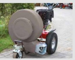
Kunststoffgehäuse für optimalen Luftfluss
