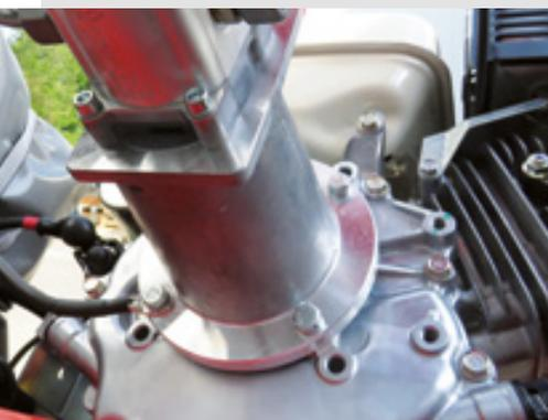
Wartungsfreie Zahnradpumpe mit Direktantrieb
