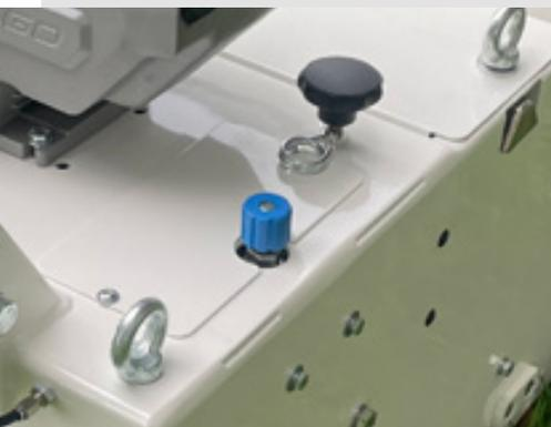
Stufenlose Geschwindigkeitsregelung der Igelwalze
