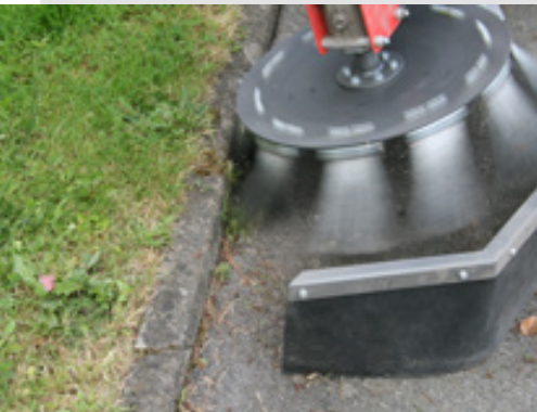
Der Spritzschutz schützt vor Steinschlag
