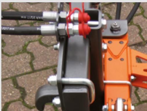
▶ Halterung für Hydraulikanschlüsse
