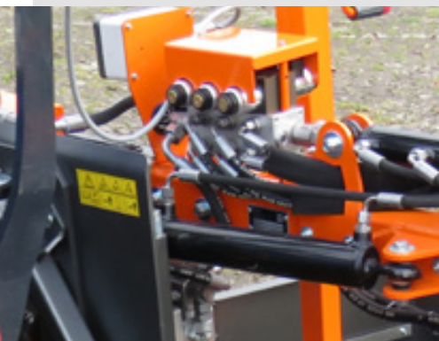
Hydraulikblock zur hydraulischen Verstellung der verschiedenen Arbeitswinkel
