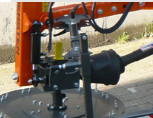
Getriebe drehbar für beide Laufrichtungen
