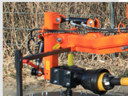
▶ Mechanische oder hydraulische Winkelverstellung
