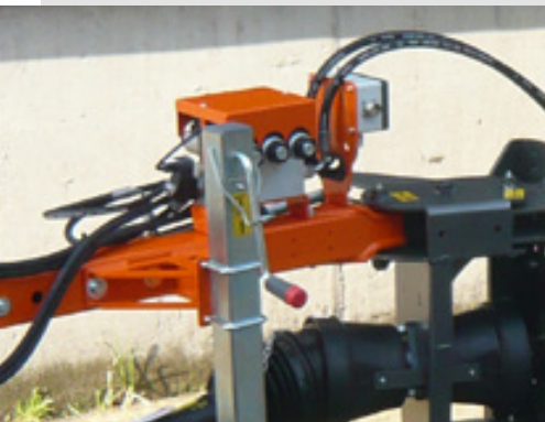
Hydraulikblock zur hydraulischen Verstellung der verschiedenen Arbeitswinkel
